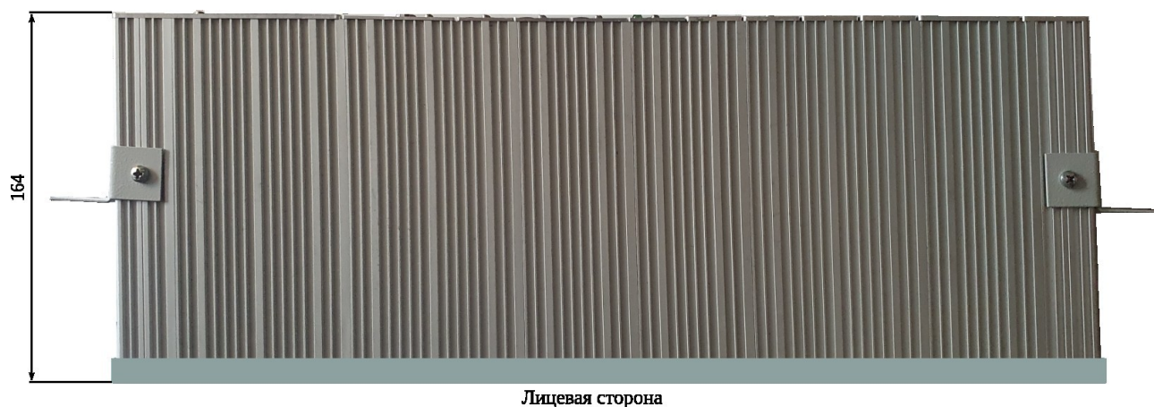
Рисунок 71: Габаритные размеры системного блока АУРА-08-КЗ (вид сверху)
