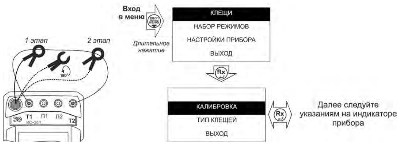
Рисунок 2.14 – Калибровка токоизмерительных клещей
