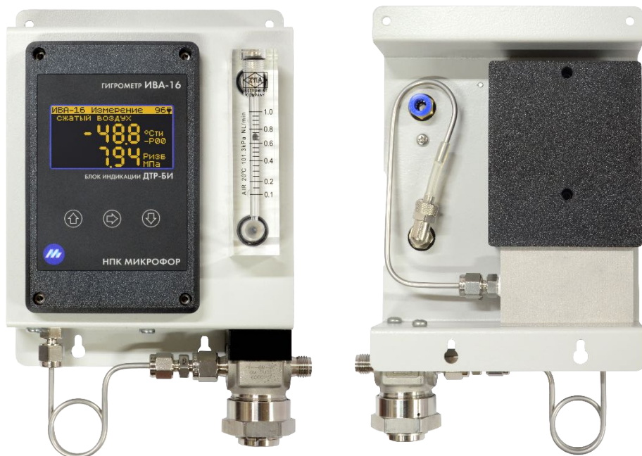
Рис. 1. Внешний вид гигрометра ИВА-16 спереди (слева) и сзади (справа).
