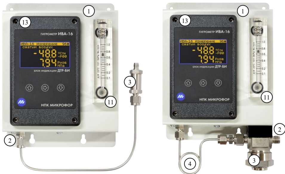
Рис. 2. Гигрометр ИВА-16 (вид спереди) с входным давлением до 20 МПа (слева) и более 20 МПа (справа).
