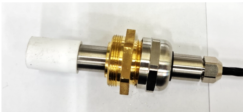
Рисунок 30 – Зонд измерения влажности перед установкой в измерительную камеру генератора.
