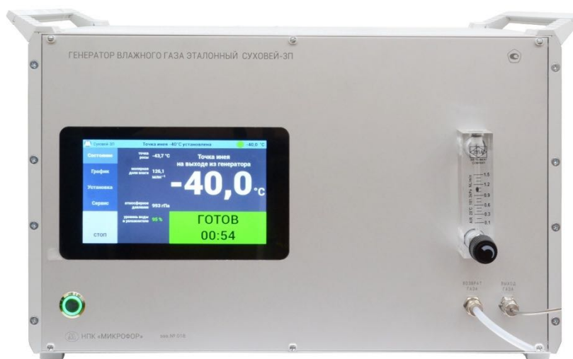
Рисунок 2 – Внешний вид передней панели генератора.
