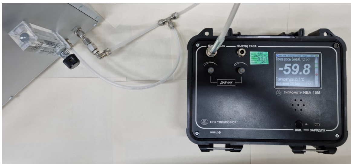
Рисунок 39 – Подключение гигрометра ИВА-10М.
