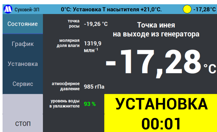
Рисунок 31 – Процесс установки температуры точки инея.
