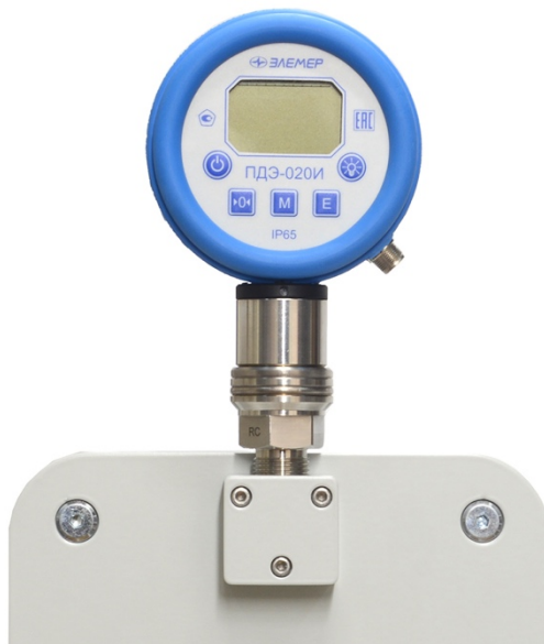
Рисунок 14 – Установка эталонного преобразователя давления ПДЭ-020И в барокамеру.
