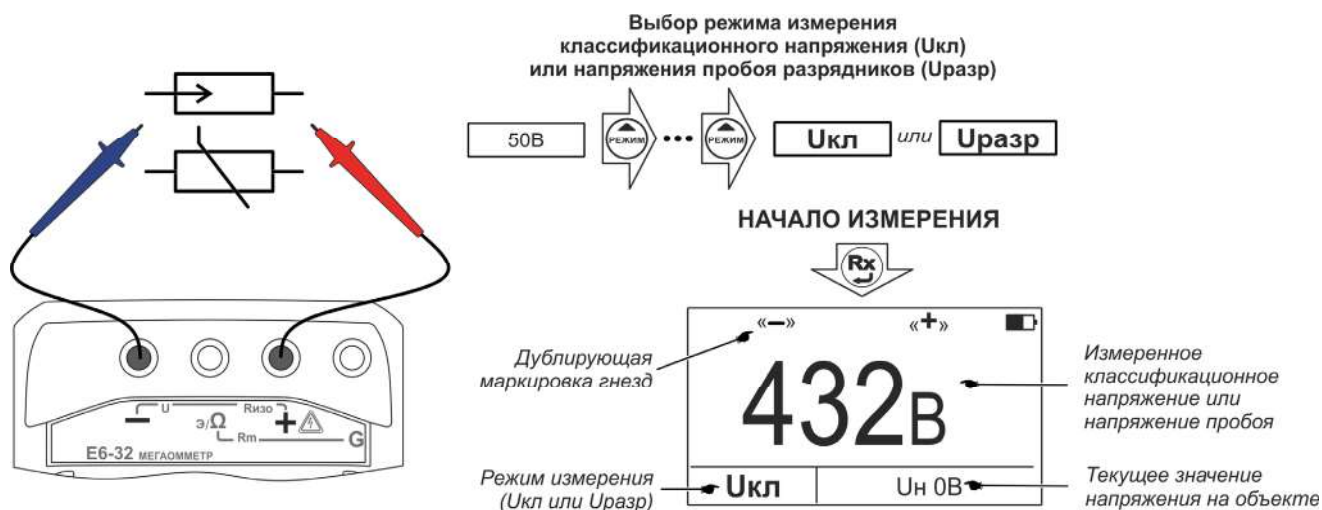
Рисунок 2.10 - Измерение классификационного напряжения или напряжения пробоя разрядников
