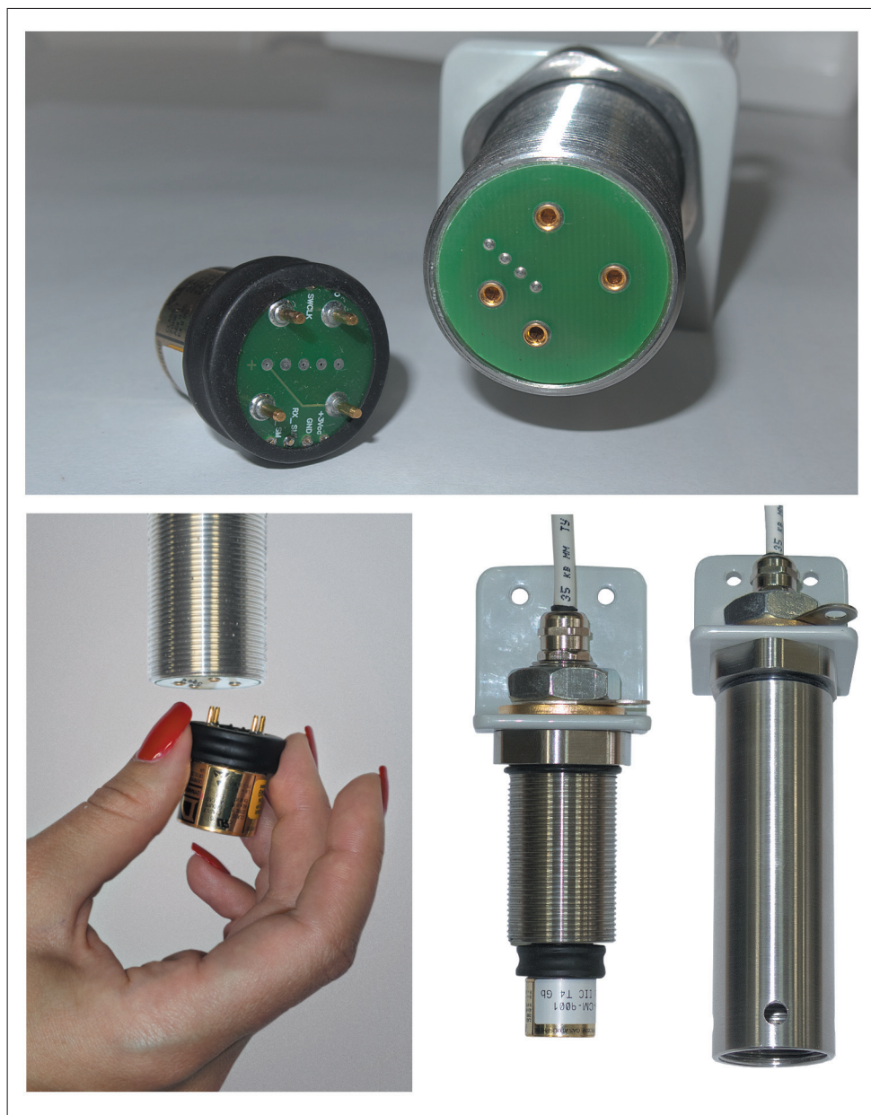
Рис.2. Подключение интеллектуального сенсорного модуля
