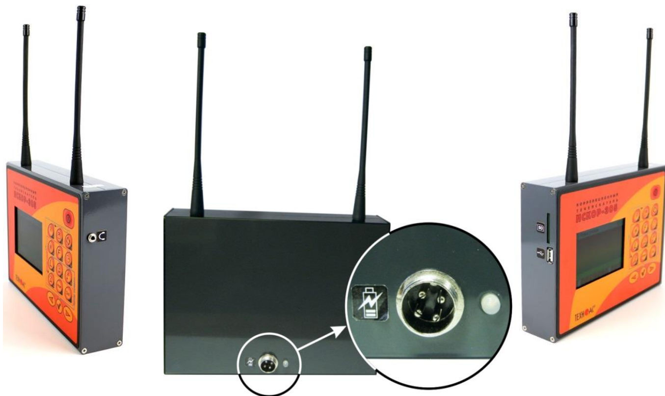
Рисунок 5 - Внешний вид корреляционного приемника «КП-305»
