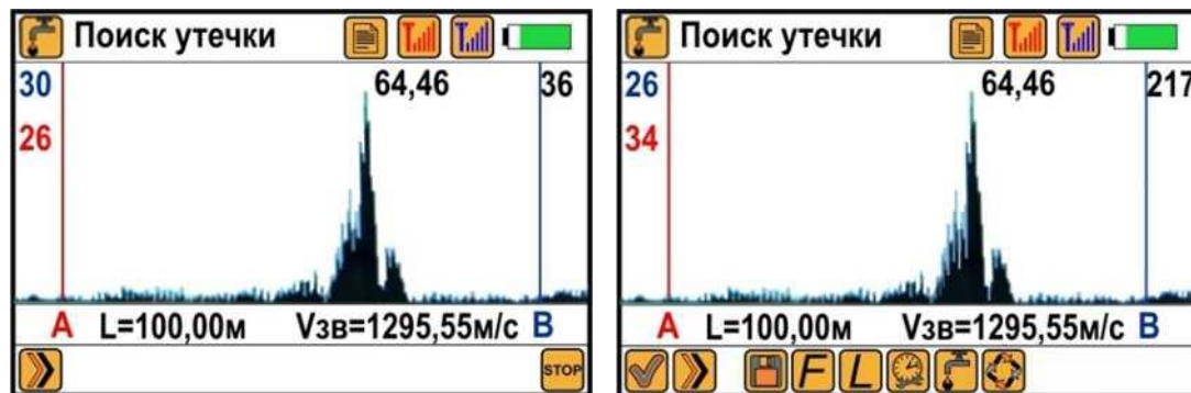
Рисунок 14 - Окно «Поиск утечки, корреляционная функция»
