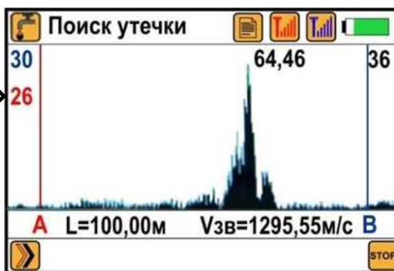
Рисунок 8 - Перегрузка принимаемого сигнала
