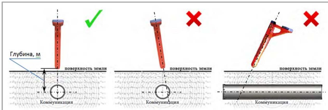
Рисунок 4 – Правильное положение приемника при замере глубины
