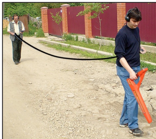
Рисунок 22 – Обследование при помощи ДОДК-117
