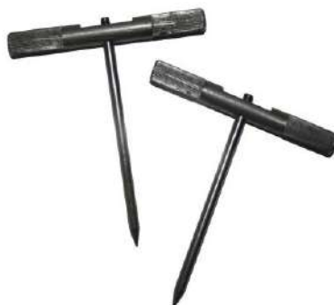
Рисунок 11 - Приспособления для крепления сейсмоприемников на грунт
