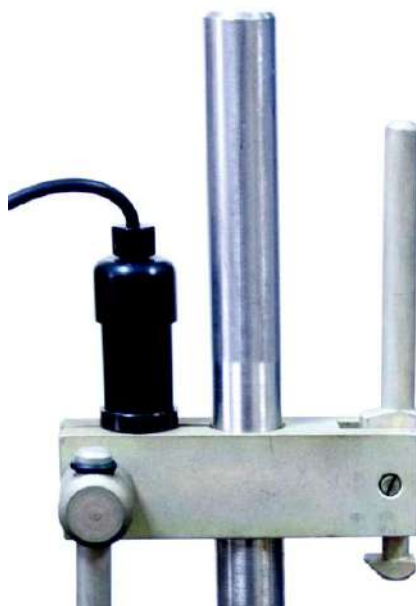
Рисунок ПБ.4 – Установка сейсмоприёмника на темпер
