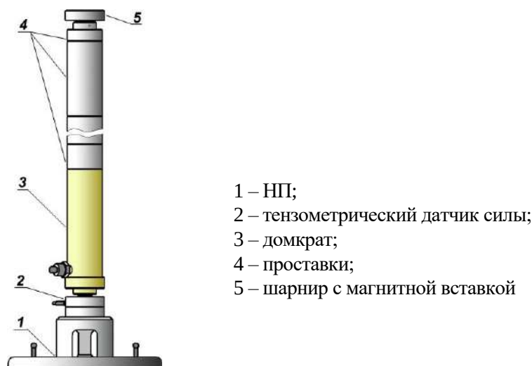
Рисунок 1.2 – Механизм нагружения
