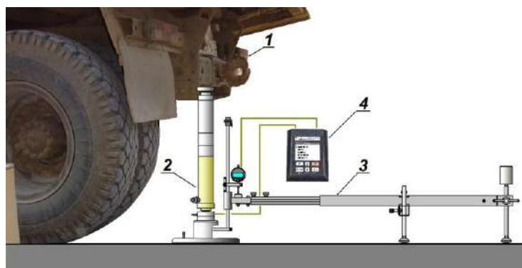
1 – противовес; 2 – механизм нагружения; 3 – устройство для измерений перемещения НП; 4 – электронный блок
