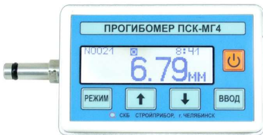
Рисунок 1.2 – Вид электронного блока прогибомера.
