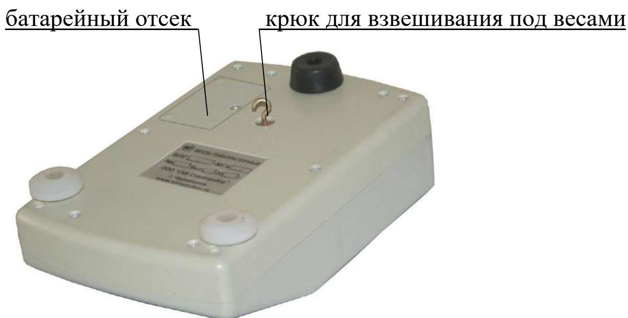
Рисунок 2 - Вид нижней крышки весов ВЛГ-МГ4.01
