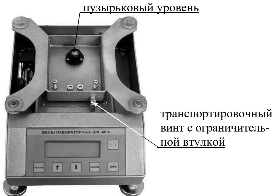
Рисунок 3 – Вид весов ВЛГ-МГ4, ВЛГ-МГ4.01 с НПВ от 5000 г до 10000 г со снятой платформой
