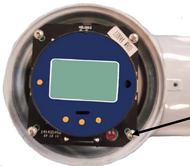
Рисунок 12. Схема пломбировки ВП МТ150НС
