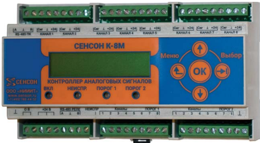
Рис.1. Контроллер аналоговых сигналов Сенсон К-8М
