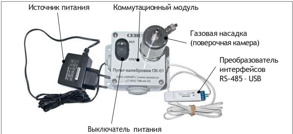
Рис. 1. Пульт калибровки ПК-01
