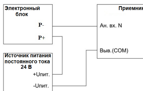
Схема подключения импульсного выхода
