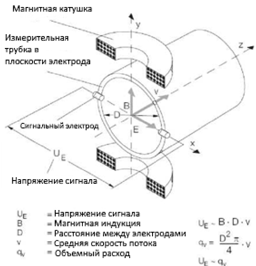
Схема электромагнитного расходомера
