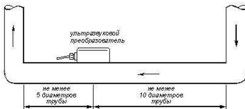
Рисунок 2 – Установка преобразователя на прямолинейном участке трубопровода (вид сверху)
