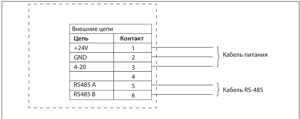
Рис.7. Схема подключения ГС "Сенсон-СД" исполнения 7032 и 7033
